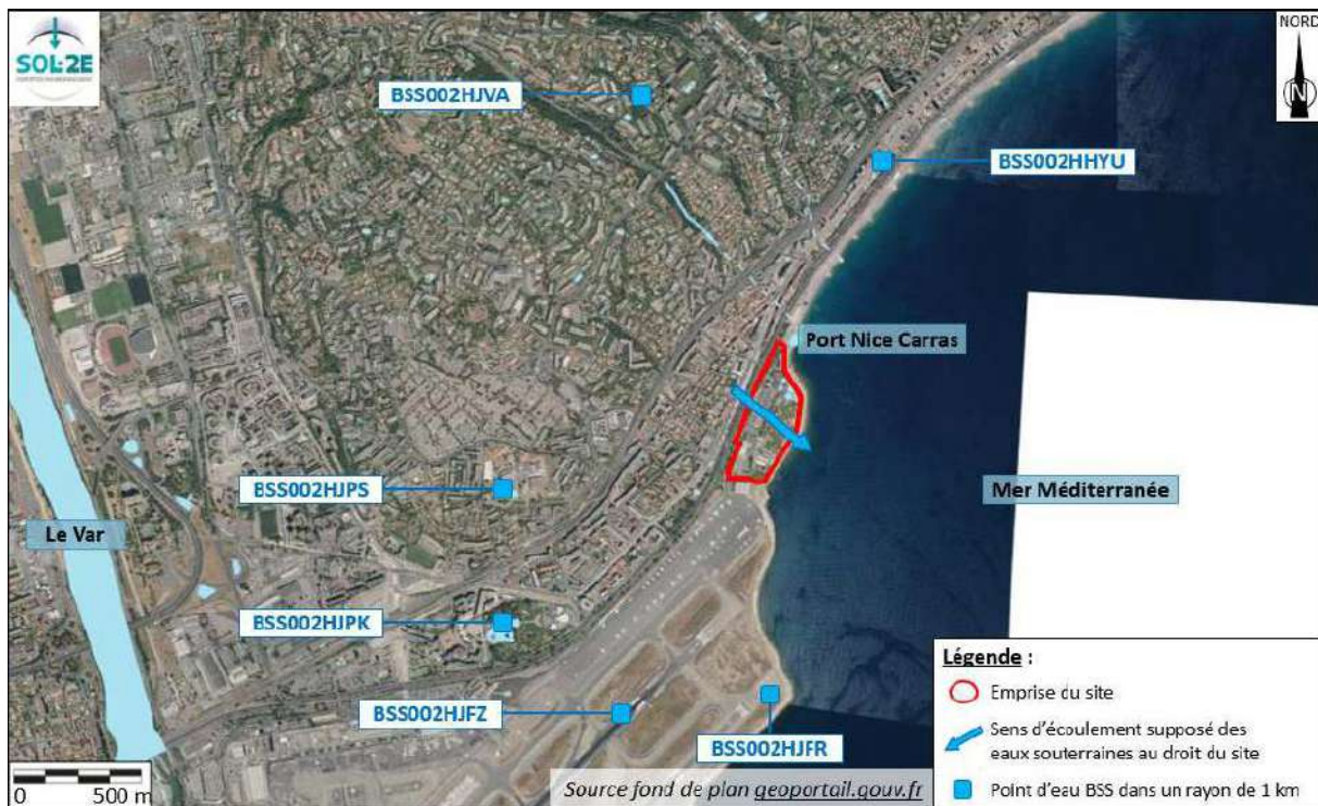
Figure 29 : Captages à proximité du site identifiés dans la base BSS du BRGM sur un rayon de 1 km autour du site (Source : Étude de la sensibilité environnementale - SOL-2E, 2020)
