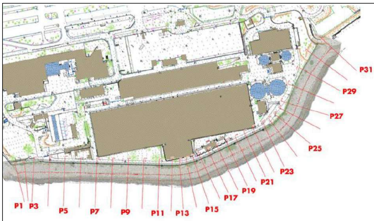
Figure 82 : Profils de la plateforme étudiés lors du diagnostic terrestre et subaquatique de l'ouvrage de protection (Source : Diagnostic de l'ouvrage de protection de la plateforme de la station HALIOTIS – CORINTHE, 2022)
