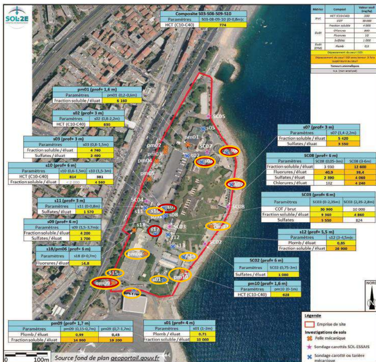
Figure 34 : Localisation des investigations de sol (Source : Diagnostic de qualité environnementale des milieux SOL-2E - 2022)
